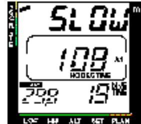
Abb. 3.13 Aufstiegs geschwindigkeitsanzeige Zeiger auf Position 4: Die Aufstiegs geschwindigkeit ist höher als 11m/ Min. (36 Fuss/ Min.). Ein blinkendes SLOW zeigt, dass die Aufstiegs geschwindigkeit von 10m/ Min (33 Fuss/ Min) dauerhaft überschritten wurde. Dies ist ein Hinweis den Aufstieg zu verlangsamen!
