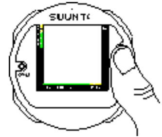
Abb. 3.2 AKTIVIERUNG DER HINTERGRUNDBELEUCHTUNG Betätigen Sie den Druckschalter, der durch das Symbol “☐ LUX” gekennzeichnet ist.
